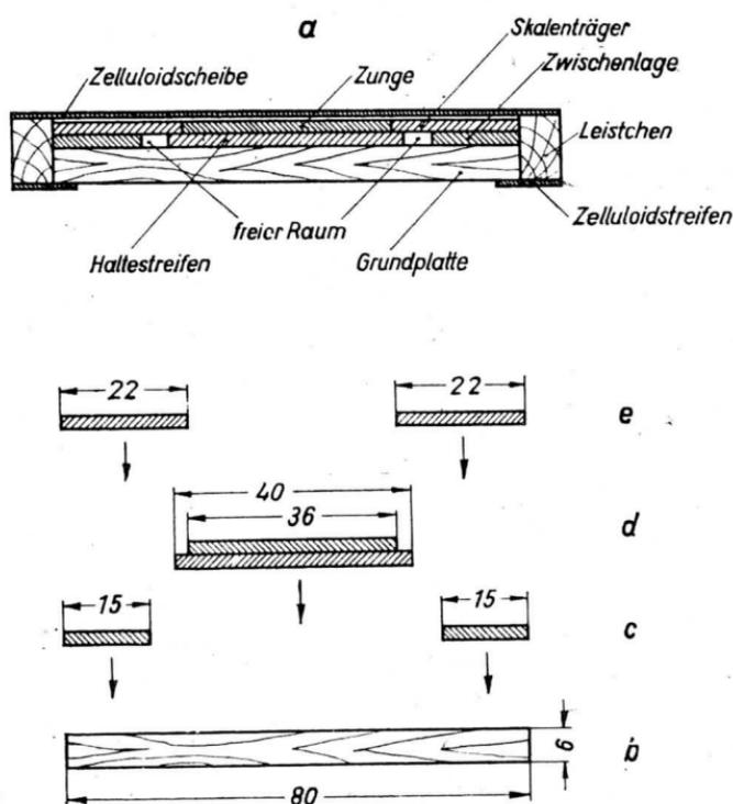
Bild 7. Der Aufbau des Rechenschiebers der zweiten Ausführungsform.
