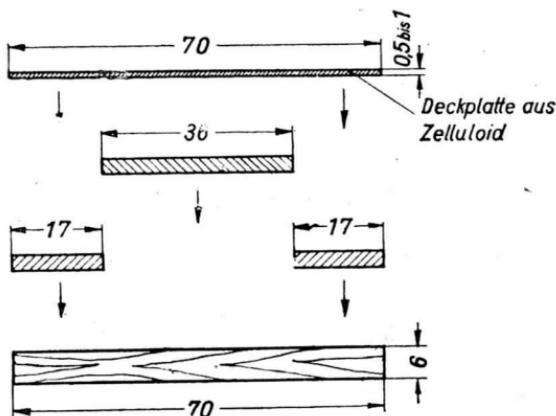
Bild 9. Die Maße der einzelnen Teile der dritten Ausführungsform.
