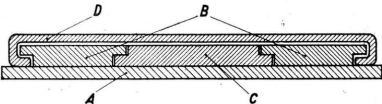
Bild 1. Der Rechenschieber im Querschnitt.
