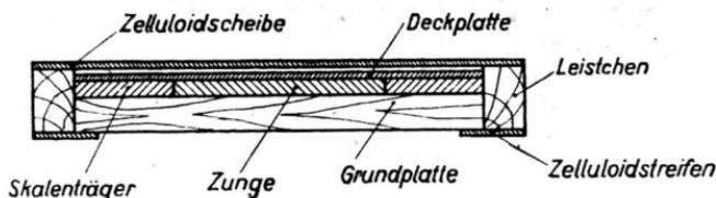
Anm.: Der Abstand zwischen der Deckplatte u. der Zelluloidscheibe des Läufers ist hier vergrößert gezeichnet.
