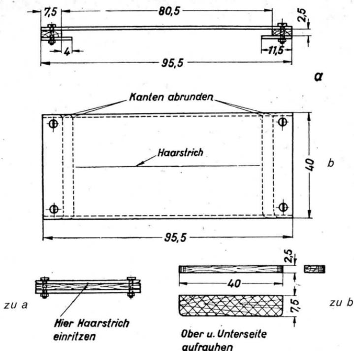
Bild 6. Maßzeichnung für den Läufer zweiter Art.
