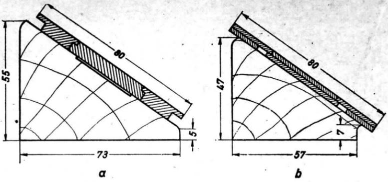
Bild 10. Für den Gebrauch am Schreibtisch empfehlen sich diese im Schnitt gezeichneten schrägen Grundplatten.
