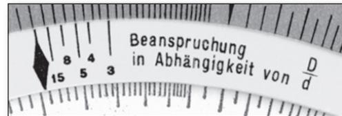
Bild 19: Vergrößerte Skala für die erhöhte Schubspannung
